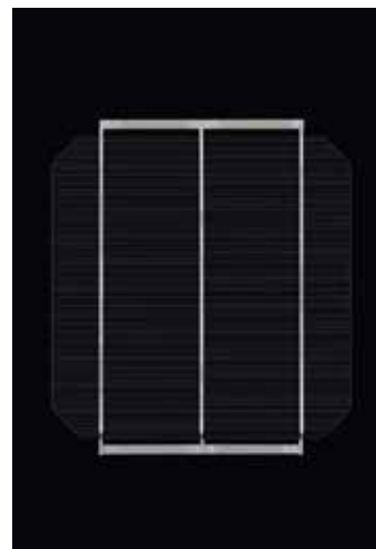
Monokristallines BiPV-Modul mit sichtbaren Leiterbahnen
