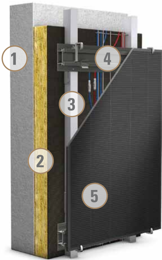
Dünnschicht- oder kristallines Photovoltaikmodul im Glasaufbau
